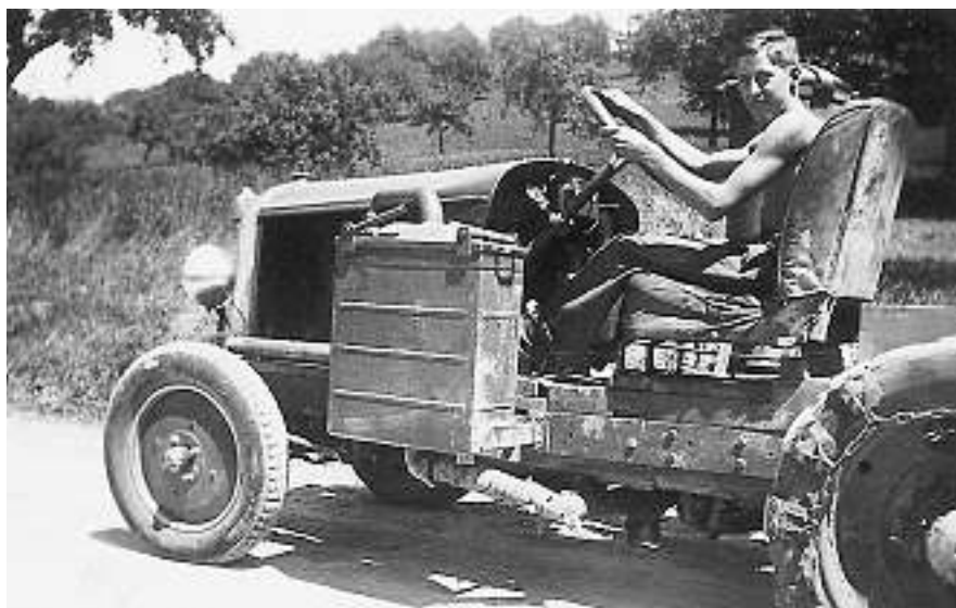
Mit Holzvergaser betriebener Traktor
